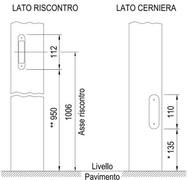
\* Se diversa da mm 135 le formule di calcolo non sono idonee alla costruzione della porta.
