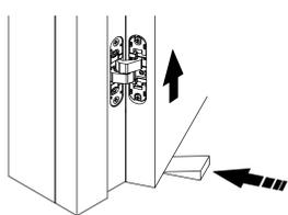
**C** Vite di fissaggio regolazione profondità.
