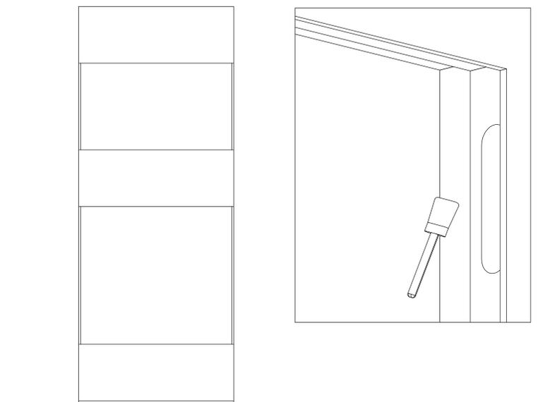
Rimuovere i distanziali in legno. Stuccare i fori delle viti. Pulire il telaio in alluminio da eventuali schizzi di cemento e procedere con la colorazione. Applicare come prima mano della cernite opportunamente diluita. Procedere all'installazione della guarnizione nel perimetro di tutto il telaio.
