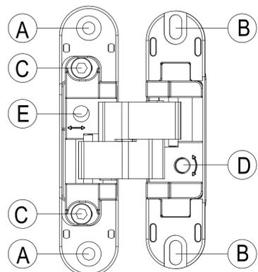
**A** Foro viti di fissaggio della cerniera al telaio.
