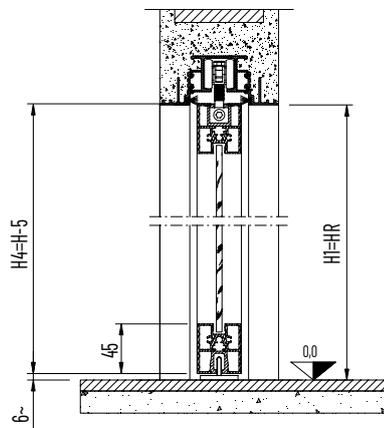
Avant de commander la porte, toujours vérifier la dimensions de passage effective une fois le contre-châssis installé.
