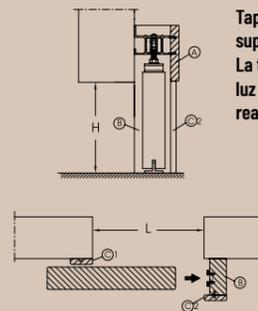
Tapeta de cobertura y tope de tablero MDF revestido en la superficie con melamina decorativa, con junta en el tope. La tapeta de cobertura y el tope deberán adaptarse siempre a la luz de paso durante la instalación, realizando unos sencillos cortes.
