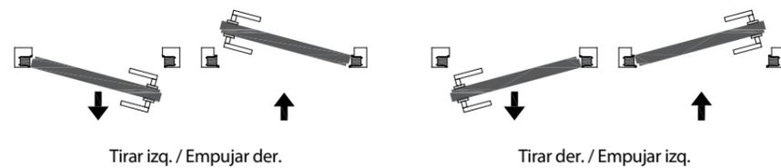
La versión con apertura de empujar permite la apertura máxima de la hoja de 90°/100°, con la consiguiente reducción de la luz de paso.
