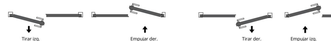
La versión con apertura de empujar permite la apertura máxima de la hoja de 90°/100°, con la consiguiente reducción de la luz de paso. Si se instalan puertas con apertura de empujar y de tirar en la misma pared, entre los dos modelos, con la misma luz de paso, el orificio de la luz del modelo con apertura de tirar presenta una diferencia en altura de + 10 mm y en anchura de + 20 mm.
