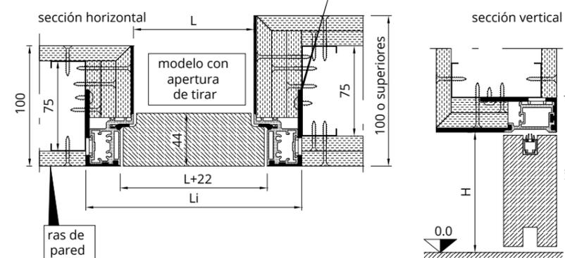
**MONTAJE EN PAREDES DE LADRILLO**
