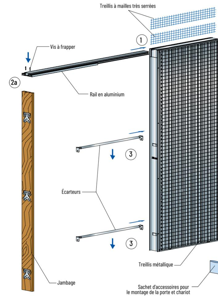
1. Insérer le rail dans le châssis.
