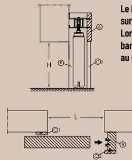
Le bandeau et la butée sont réalisés en MDF recouverts en surface de décoration mélaminée, avec un joint sur la butée. Lors de l'installation, il est nécessaire de toujours adapter le bandeau et la butée à l'ouverture de passage, au moyen de simples découpes.
