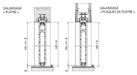
Avant de commander la porte, il est nécessaire de vérifier sur place les mesures réelles de l'ouverture de passage.
