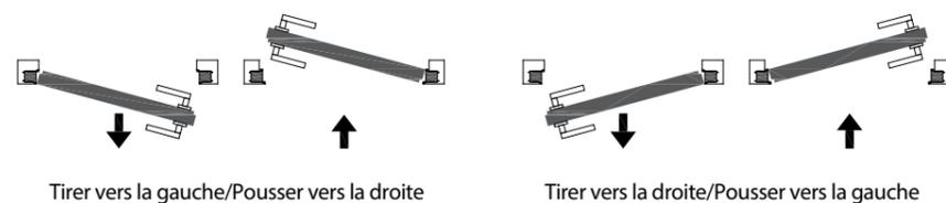
La version à pousser permet une ouverture maximale du vantail à 90° / 100°, réduisant de fait l'ouverture de passage.
