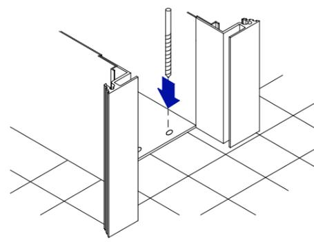
SI NECESSAIRE REPASSER AVEC UN FORET DIAMETRE 3 LES TROUS DE FIXATION DU GUIDE DE COULISEMENT.
