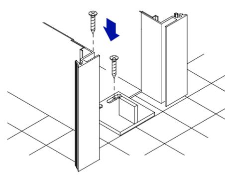
FIXER LE GUIDE EN UTILISANT LES VIS 4.2X9,5 FOURNIES. SI LE CAISSON A ETE MONTE EN-DESSOUS DU NIVEAU DU SOL FINI, UTILISER LES ENTRETOISES FOURNIES POUR LE REHAUSSER ET DANS CE CAS UTILISER LES VIS 4.2X19.FOURNIES
