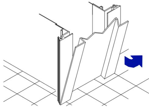
UNE FOIS L'ENDUIT BIEN SEC, ENLEVER LES CACHES ET LES CALES INTERNES EN POLYSTYRENE. NETTOYER SOIGNEUSEMENT L'INTERIEUR DU CAISSON.
